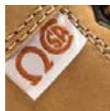
Enfin, un autre sigle important que vous pouvez apercevoir sur des bottes de sécurité est la lettre grecque oméga. Ce sigle signifie que les bottes sont munies d'une semelle résistante aux décharges électriques. Un travailleur qui risque d'entrer en contact avec un conducteur électrique sous tension doit s'assurer de retrouver ce sigle sur ses bottes de sécurité.
