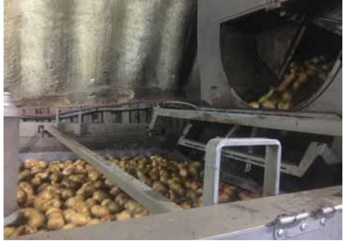
*Nettoyeur de patates automatisé*
