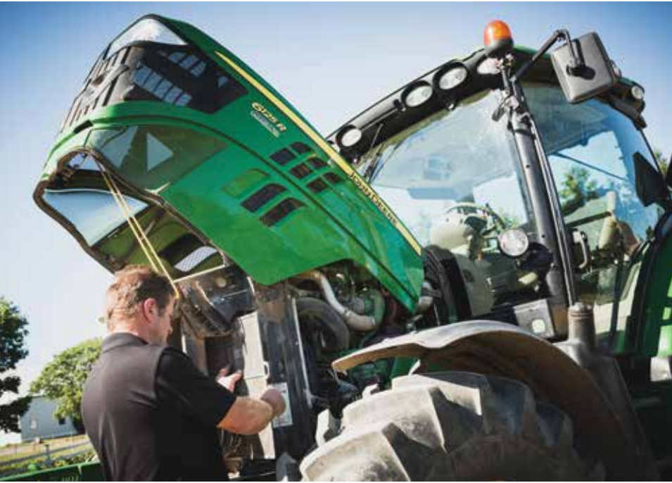
Alain inspecte les divers filtres pour s'assurer d'un fonctionnement efficace.
