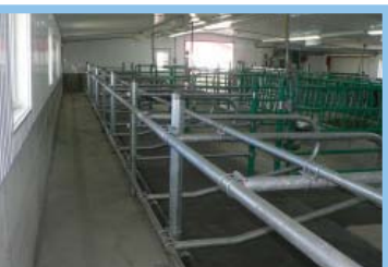
Une allée de trois pieds de chaque côté à la tête des taures facilite l'écurage.
